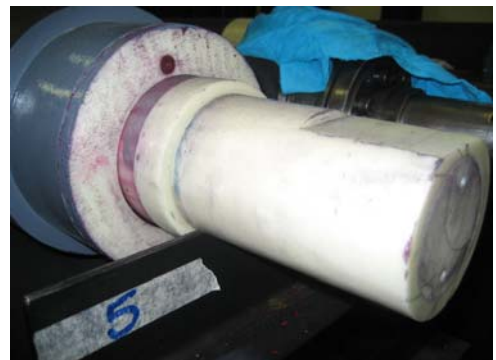
Aislamiento de eje no permitido en zona EX
