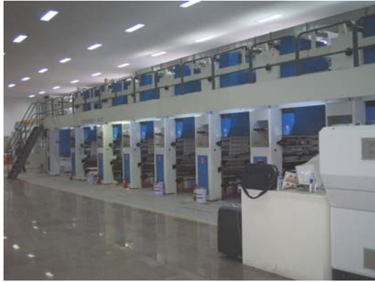
CMR ROTOSPEED 3001 (4 ACE Rotostatic units instalados)
