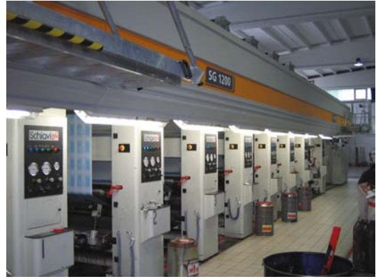
SCHIAVI SG1200 (8 ACE Rotostatic units instalados)
